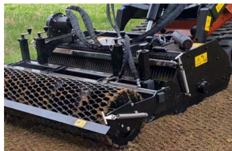
Option : Déplacement hydraulique du châssis rouleau
