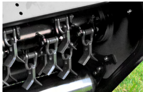
Montage en Y des couteaux sur manilles
