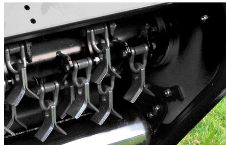
Montage en Y des couteaux sur manilles
