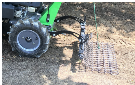
Ratissage et hersage de finitions
