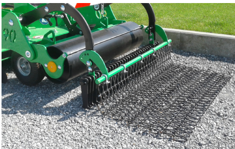
Ratissage, hersage et rouleau arrière pour une finition lisse
