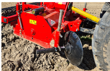
Option : Disques avant pour formation du sillon
