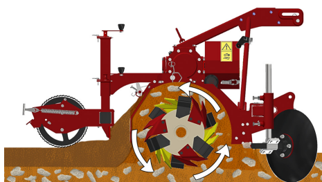
Principe de préparation du sol
