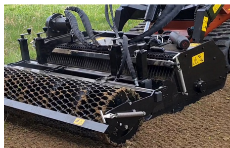
Option : Déplacement hydraulique du châssis rouleau
