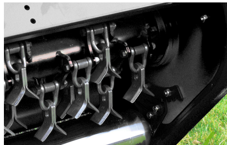
Montage en Y des couteaux sur manilles
